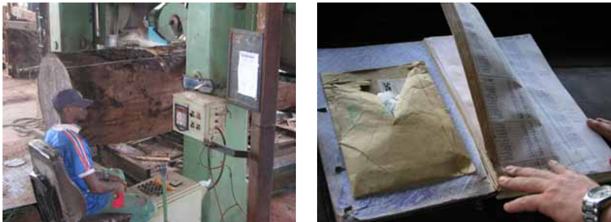
Figure 14. Billon entrant sur la scie de tête (photo de gauche) et cahier de relevé des caractéristiques des billons entrant en scierie (photo de droite) © M. Vandenhautte
