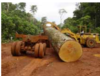
Figure 13. Chargement d'une bille sur un grumier et transport vers la destination suivante. © M. Vandehaute
