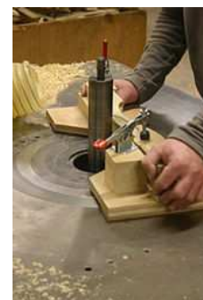
Figure 29 : Toupillage au gabarit d'une pièce de bois
