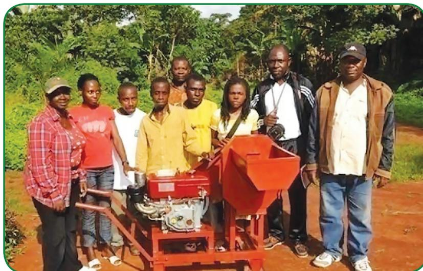
*Photo 5 : machine pour le concassage du djansang*
