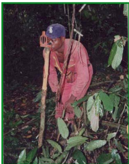
Photo1 : Un boussolier fait une visée lors de l'ouverture de la limite
